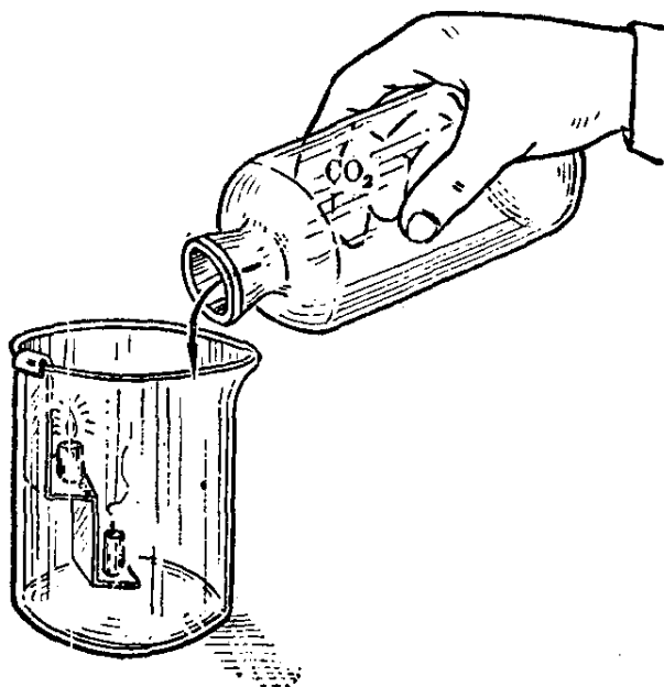
图 3·5 倾倒 \text{CO}_2 灭火的实验
